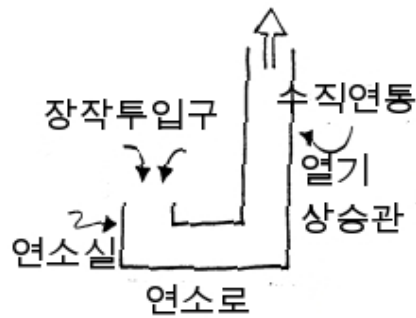
(그림6-4 로켓매스히터 연소부 로켓엘보의 'J' 자 구조)
